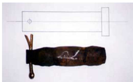
写真1 既設連結ピンの腐食状況
