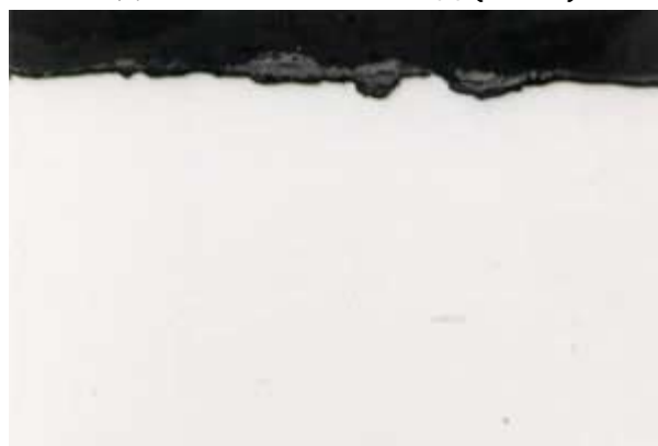
写真6 CASE-B SCM435-H 断面 (×200)
