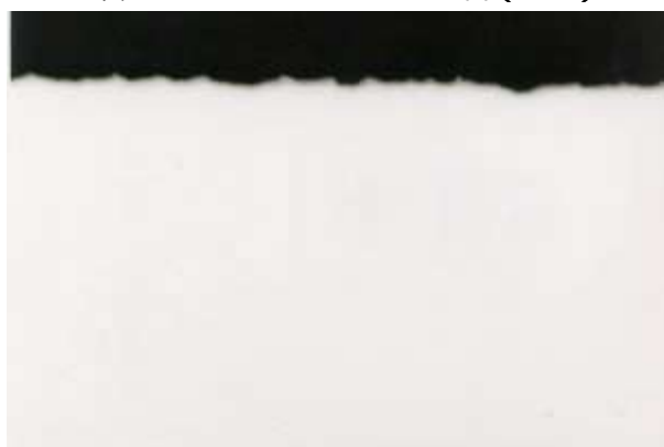
写真4 CASE-D S45C-N 断面 (×25)
