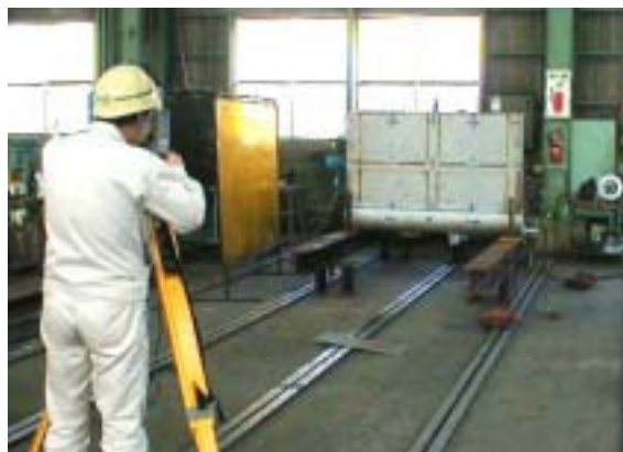
写真1 モデルワーク三次元計測状況
